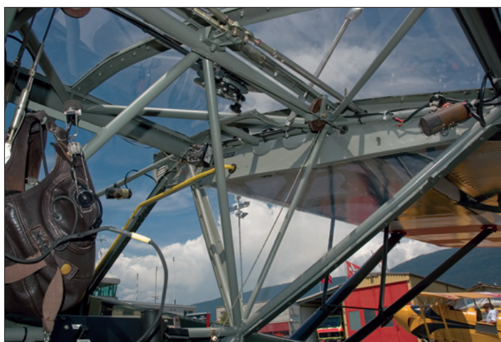
Podczas remontu samolot rozebrano na czynniki pierwsze, również kratownicę centroplata
